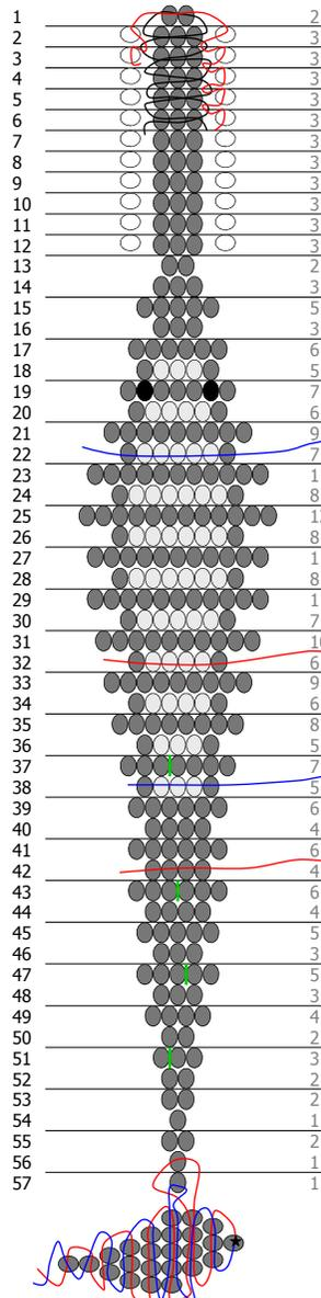
Beginnt damit, die Säge flach in die Mitte des Drahtes (1m) zu fädeln. (Die Zähne kommen erst später.)
